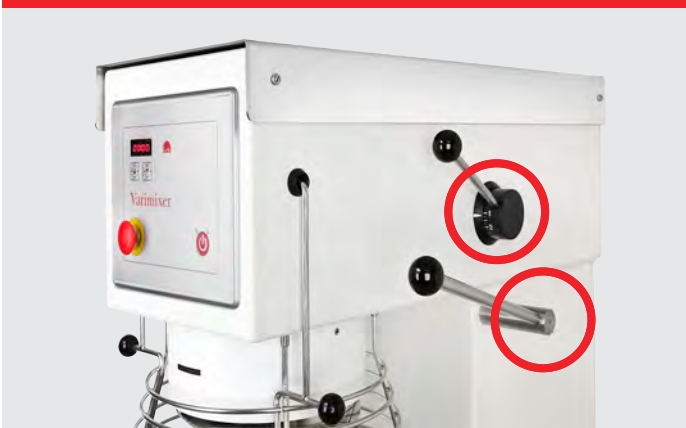
VL-1 – Manuel hastighedsregulering og manuel kedelsænkning
