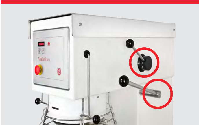
VL-1 – Manuel hastighedsregulering og manuel kedelsænkning
