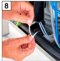
8 För avlastning, fäst nätanslutningskabeln med ett buntband på montageplattan.
