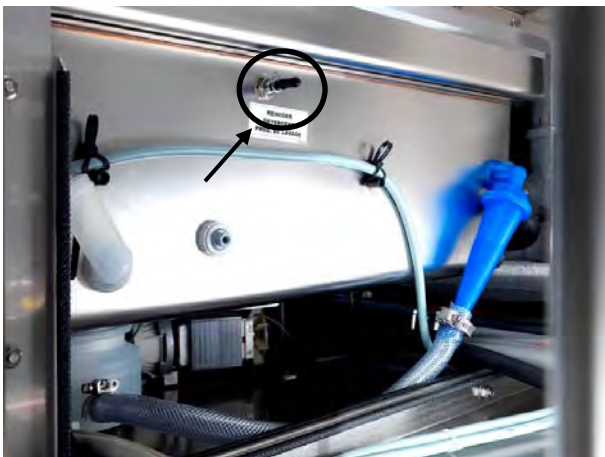
Bild: första huvuddiskningszon med doseringsnippen för rengöringsmedel
