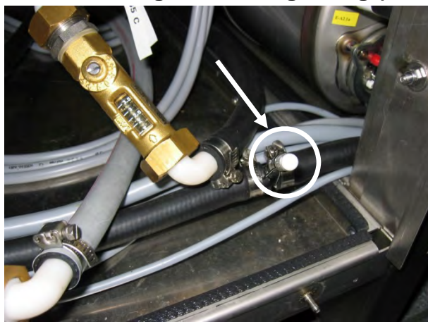
Bild: sista huvuddiskningszon med doseringsnippel för sköljningsmedel
