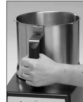
2) Vrid bunken åt höger tills motorblockets låssprintar sitter i rätt läge.
