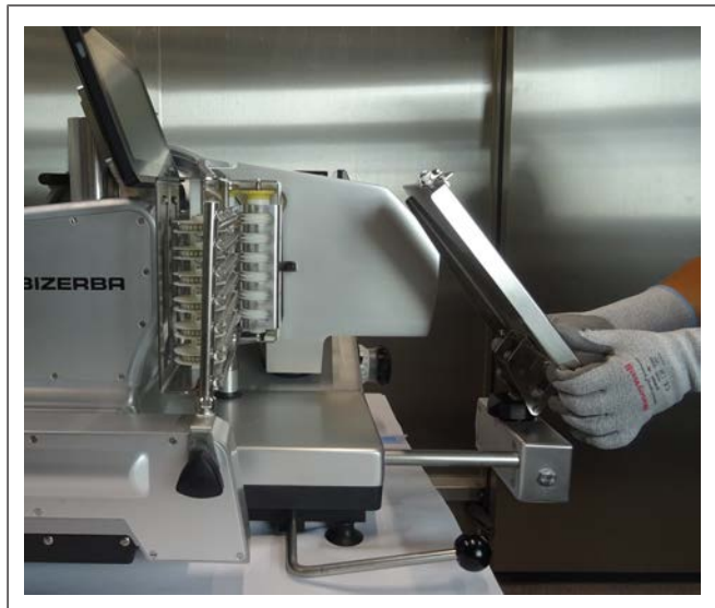
Fig. 128: Sett på oppsamlingsbrettet
