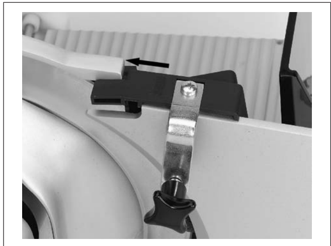
Fig. 93: Skru fast slipeapparatet
