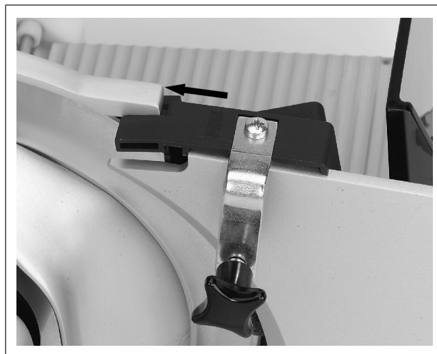
Fig. 120: Klem fast slipeapparatet
