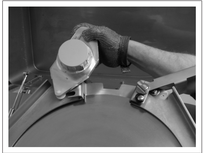
Fig. 71: Sette opp slipeapparatet
