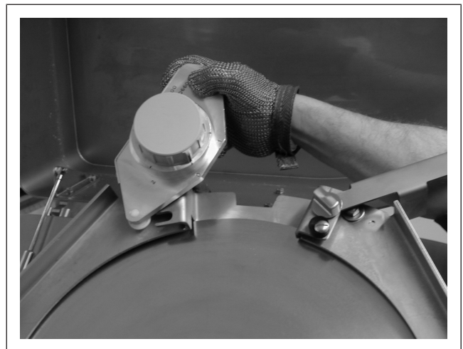
Fig. 76: Fjerning av slipeapparatet
