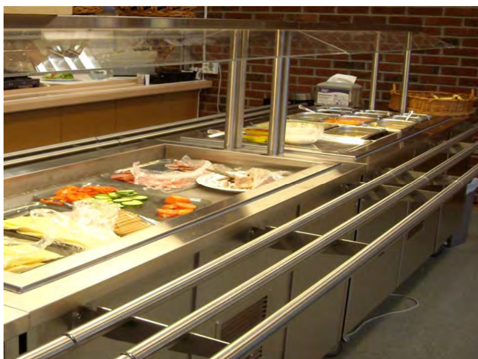
Kjølt brønn KBK, overhulle OHB, rørbrettbane
