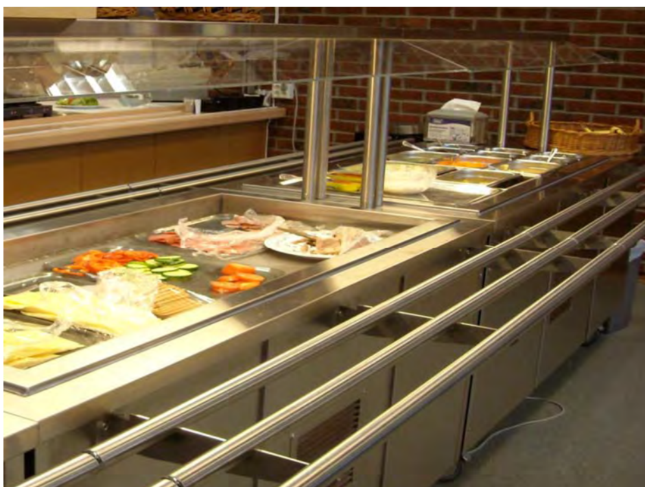
Kjølt brønn KBK, overhulle OHB, rørbrettbane
