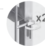
A-VT-U2 Swing lock on both sides Dispositif antibasculement des deux côtés Schwenkbare Transportversicherung auf beiden Seiten
