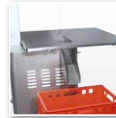
Schnittgutschacht Cutting good shaft
